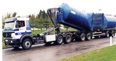
Multilift HLZ 26 -koukkuvaihtolavalaitteella varustettu yhdistelmäajoneuvo pystyy kuljettamaan kolme täyteen puristettua jätekonttia kerrallaan siirtokuorma-asemalta kaatopaikalle. Jätekontit tyhjennetään koukkulaitteella kippaamalla.
