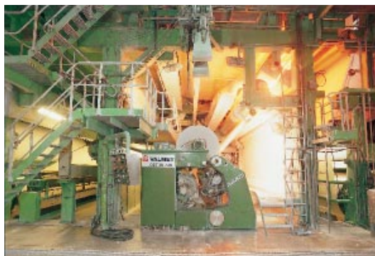
Keskuslaboratorion Optiblade-päällystyskone ajoi tammikuussa 1996 päällystyskoneiden nopeusennätykseksi 2503 m/min. Kuvassa UPM-Kymmenen Kaukaan tehtaalle toimitettu Optiblade-päällystyskone LWC-paperilajea varten.
