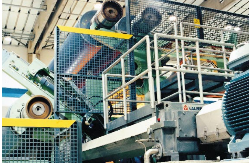
Rullaussylinterin käyttö on osa Aylesford PK 14:lle toimitettua mekaanista käyttöjärjestelmää.
