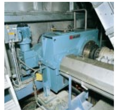
Valmetin jenkki-sylinterille kehittämä käyttö parantaa koneen ajettavuutta.
