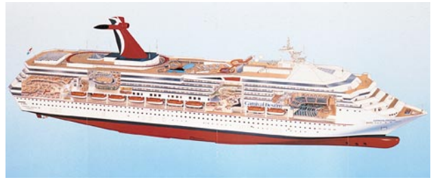
Maailman suurimmassa risteilijässä m/s Carnival Destinyssä toimivat ABB:n sähköinen voimalaitos ja potkurikäytöt.
