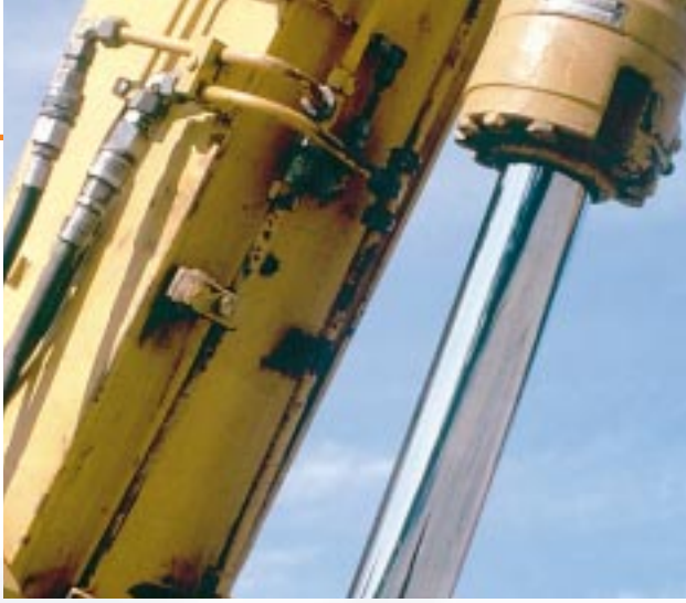
Fundian kromattuja tankoja käytetään mm. hydraulimäntien varsissa
