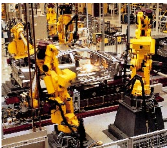
Erikoisautot valmistetaan hitsaamossa pitkälle automatisoidulla joustavalla tuotantolinjalla.
