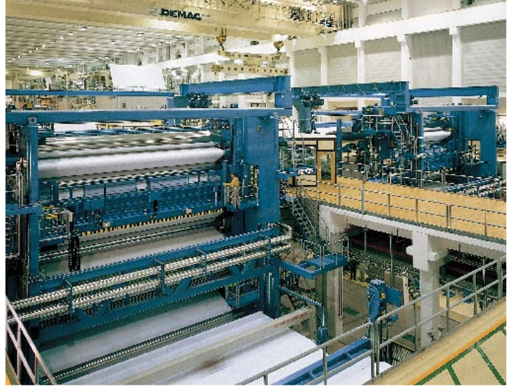
Kaksi Dura-polymeriteloin varustettua 9,5 metrin levyistä superkalanteria UPM-Kymmene -konsernin Nordland Papierin tehtaalla Saksassa.
