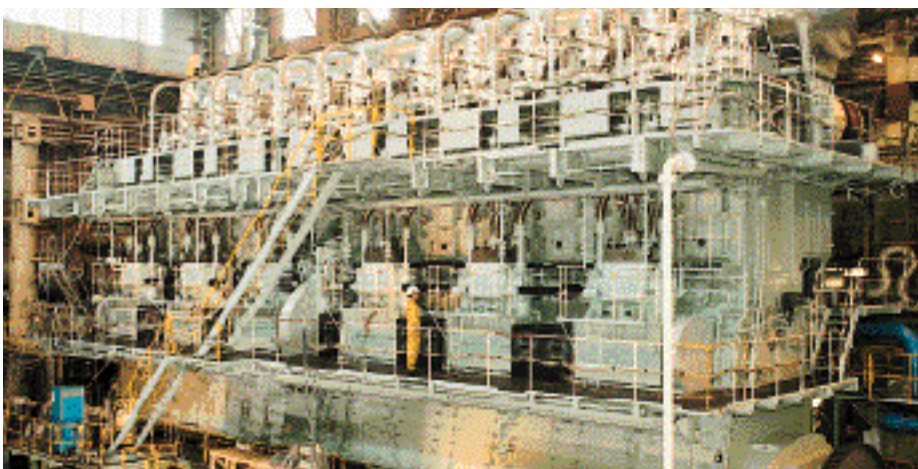
Voimala- ja laivakäyttöön soveltuva Wärtsilä 64 on maailman suurin keskinopea dieselmoottori. Kuvassa moottorin pakoputkiston asennusvaihe.
