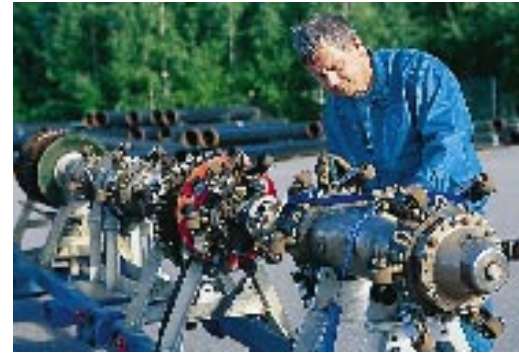
Maakaasuputkiston puhdistukseen ja kunnon analysointiin käytetään erilaisia "porsaita", jotka ajetaan putkiston läpi kaasun paineella.
