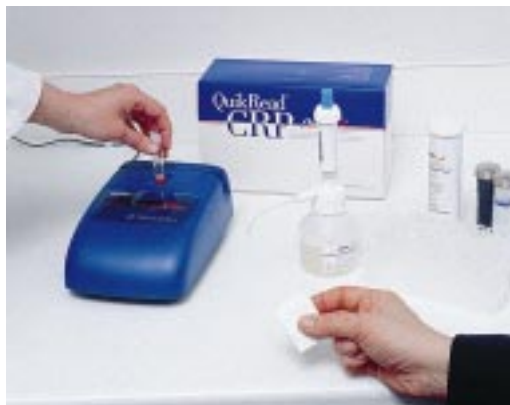
Uusi QuikRead on entistä nopeampi kvantitatiivinen menetelmä CRP:n määrittämiseksi kokoverestä. Laitetta on helppo käyttää ja se antaa tulokset alle neljässä minuutissa.
