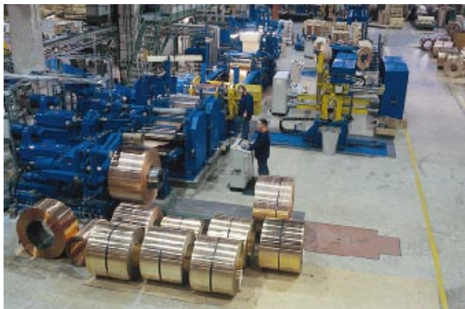
Porin valssaamo valmistautuu vuonna 2002 käyttöönotettavien euro-kolikoiden Nordic Gold-seoksen tuotantoon ja meistaamo uusien kolikkoaihioiden valmistamiseen.
