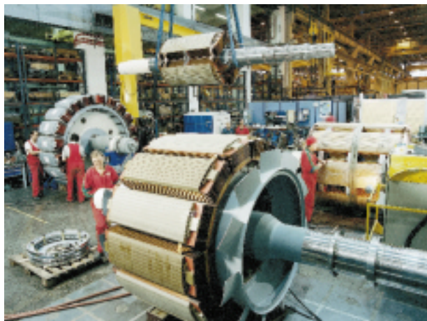
Teemme pitkäjänteistä ja tiivistä yhteistyötä ABB:n eriyksiköiden kanssa tuotekehitysprosesseissa ja tilaus/toimitus -prosesseissa. Kuvassa tahtikoneiden roottoireita valmistamassa ABB:n Pitäjänmäen tehtaalla.
