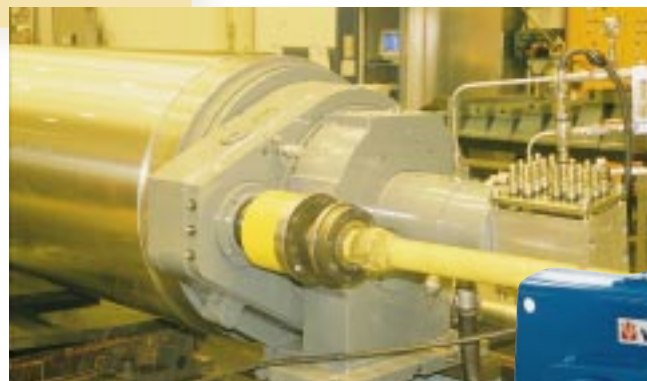
Uuden sukupolven integroidut telavaihteet takaavat koneen hyvän ajettavuuden korkeilla ratanopeuksilla.
