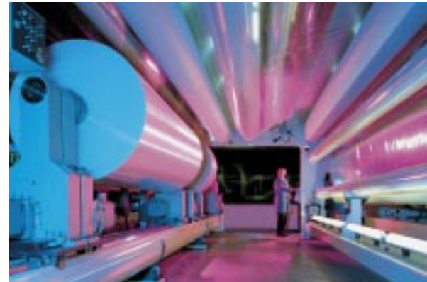
Atlasen 9,5 metrin levyinen filmin leikkaamiseen tarkoitettu jatkojalostusleikkuri on uuden jatkojalostuskoneryhmän hyvin menestyneitä tuotteita.
