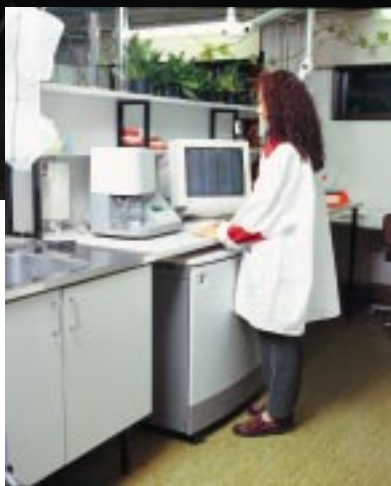
Kajaani FiberLab tarjoaa ainutlaatuisen tarkan kuidunpituusmittauksen sekä uusina ominaisuuksina kuidun leveyden ja soluseinämän paksuuden mittauksen.
