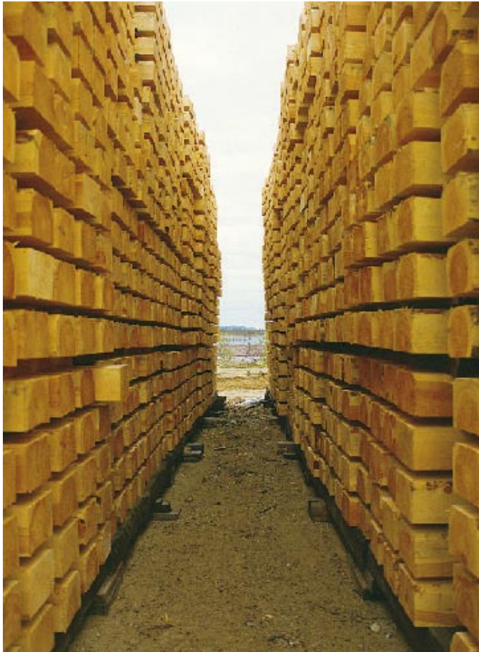
Vapo Timber Oy tutki muun muassa VTT:n kanssa rata-pölkkyjen lahonsuojausta.
