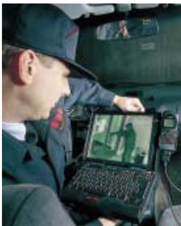
VTT Tietotekniikan kehittämän MVQ-videokoodausmenetelmän pohjalta toteutettiin ohjelmistotuote langattomaan videovalvontaan.
