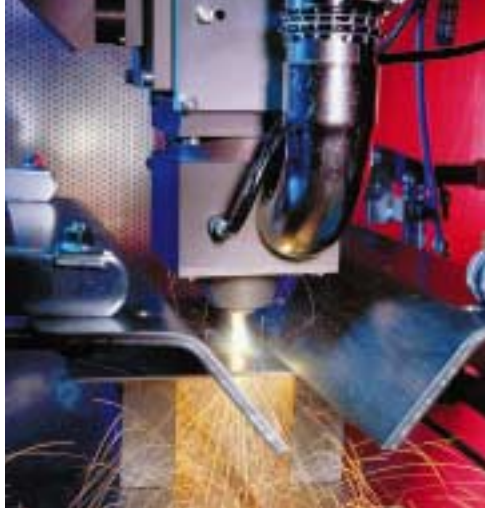
Suomen ensimmäinen suuritehoinen Nd:YAG-laser palvelee uuden laserteknologian siirtämisessä konepajoihin.
