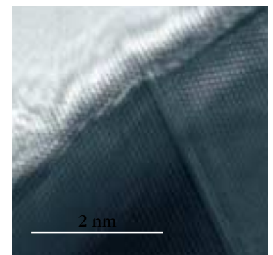
Atomitason erotuskyvyn läpäisyelektronimikroskooppikuva hopeahiukkasen pinnasta.
