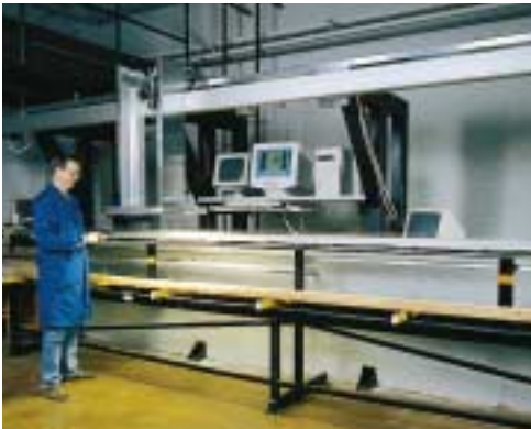
Mekaanisen metsäteollisuuden raaka-aineen mallintamisessa käytetään värikameraan perustuvaa konenäköjärjestelmää.
