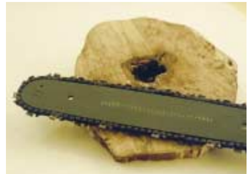
Teräslaiipan laboanturi mittaa labon läpimitan.
