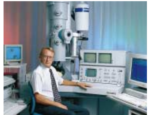
VTT:lle bankittu Suomen ensimmäinen suuren erotuskyvyn analyyttinen läpivalaisuelektronimikroskooppi parantaa merkittävästi materiaalien tutkimusmahdollisuuksia.
