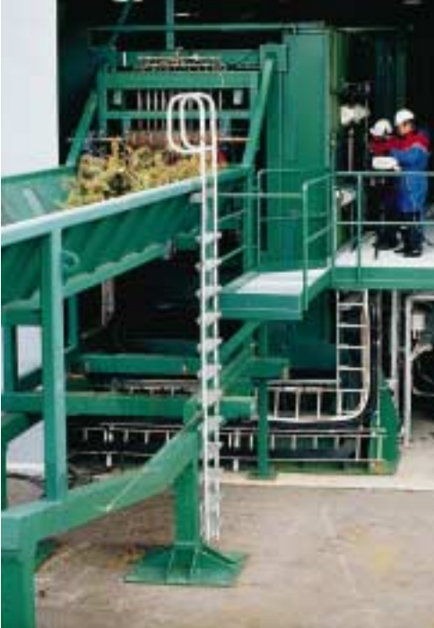
Kokopuun käsittelyn tutkimuslaitteisto tukee karsinnan, kuorinnan, haketuksen ja seulonnan menetelmien kehittämistä.
