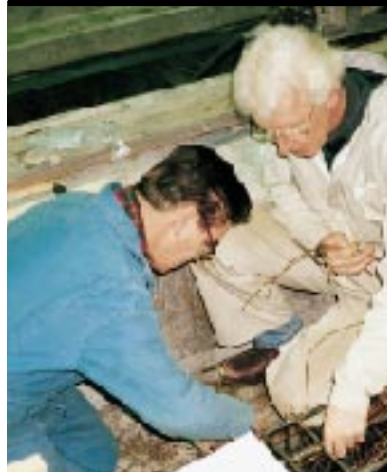
Korkealujuuksisen betonin palonkestävyyttä tutkittiin EU rahoitteisessa projektissa (HITECO). Kuvassa asennetaan termoelementtejä koekappalemuottiin.
