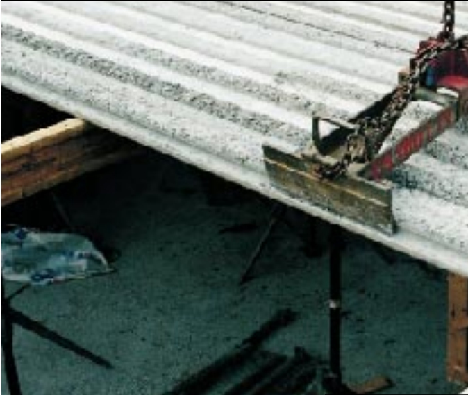
Korkealujuuksisen betonin palonkestävyyttä tutkittiin EU rahoitteisessa projektissa (HITECO). Kuvassa asennetaan termoelementtejä koekappalemuottiin.
