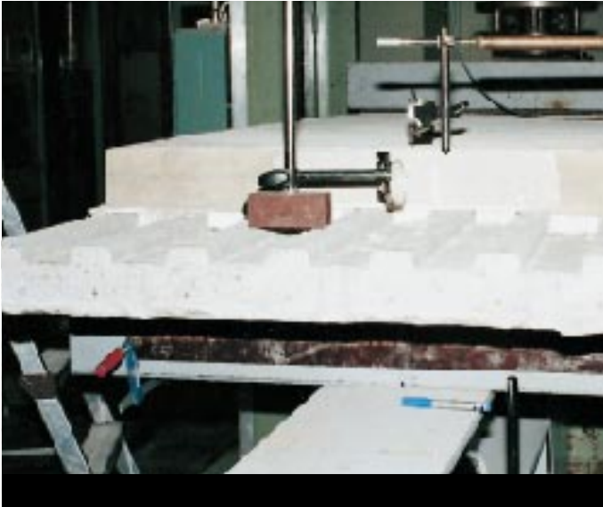
Uudentyyppisen kuorilaatan kantokykytestit suoritettiin Addtek R&D:n laboratoriossa Paraisilla.
