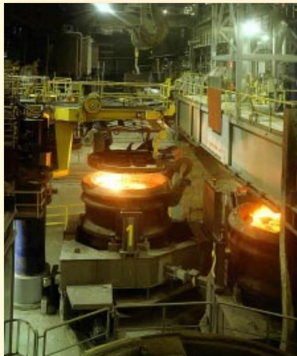
Raahan terästehtaan uusi senkkametalurginen laitos avaa mahdollisuuksia uusien teräslajien kehittämiseksi.
