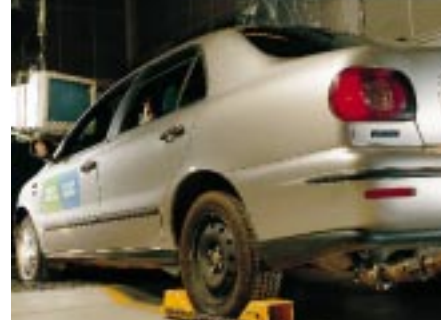
Kemira Metalkatin laboratoriossa testataan pakokaasukatalysaattoria, joka soveltuu kahdella vaihtoehtoisella polttoaineella, maakaasulla ja bensiinillä, toimimaan autoon. (Kuva: Studio Karl Labti)
