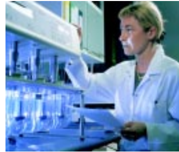
Monica Hildén työskentelee liukenemisnopeuden analysointiin käytettävän laitteiston äärellä. Laitteistolla analysoidaan suullisesti annosteltavista lääkevalmisteista vapautuvan vaikuttavan aineen liukenemista.
