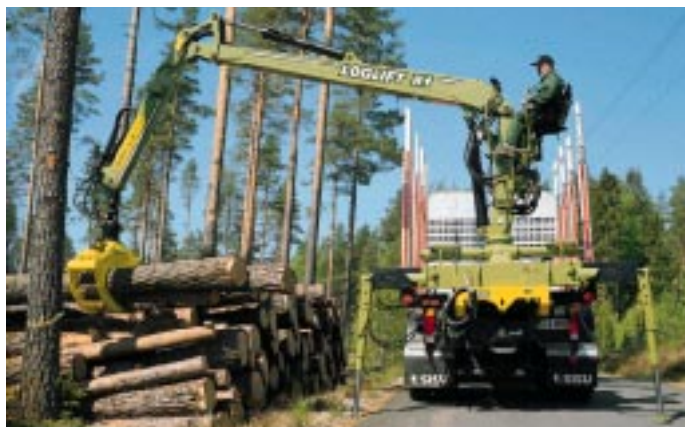
Tavaralajimenetelmä perustuu nosturin käyttöön ketjun eri vaiheissa, minkä ansiosta puutavaran laatu pysyy hyvänä.
