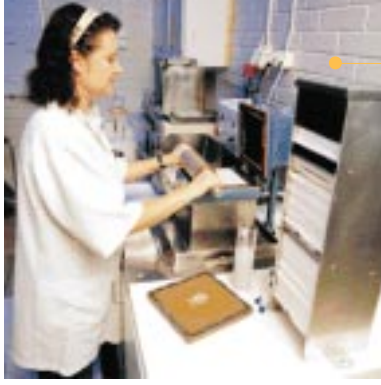
Laborantti Hanna Sipilä valmistaa testikartonkia, jolla voidaan tutkia kemikaalien tarttumista kuituun ja sidosten muodostumista.
