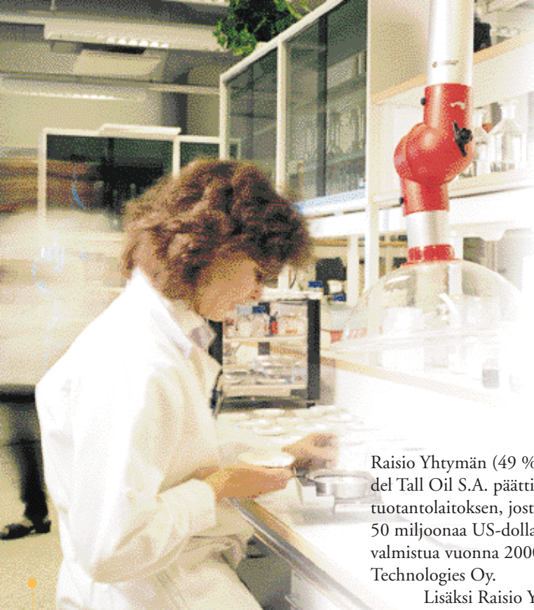
Laborantti Tarja Hörkkö määrittää halogeenikuiva-aineanalysaattorilla sterolijauheen kuiva-ainepitoisuutta.
