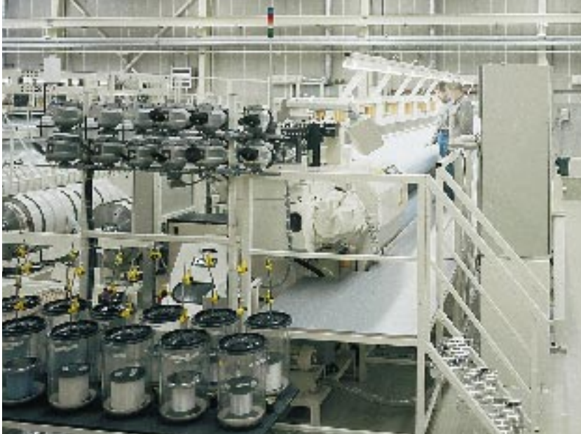
Juankosken tehdas uusi 13,5 m leveä Jäger-kutomakone mahdollistaa viirojen kudonnan maailman leveimmille paperikoneille.
