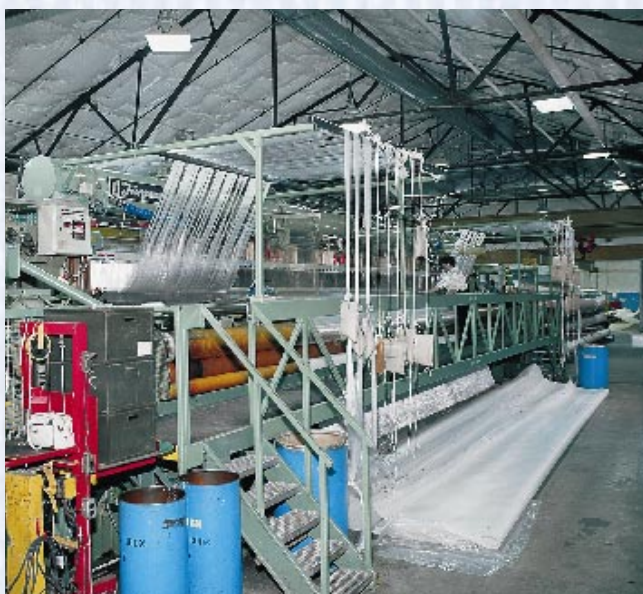
Kutomakone Cantonissa on uusittu viimeisimpien saumallisten puristinhuopatyypin tuotantoon.
