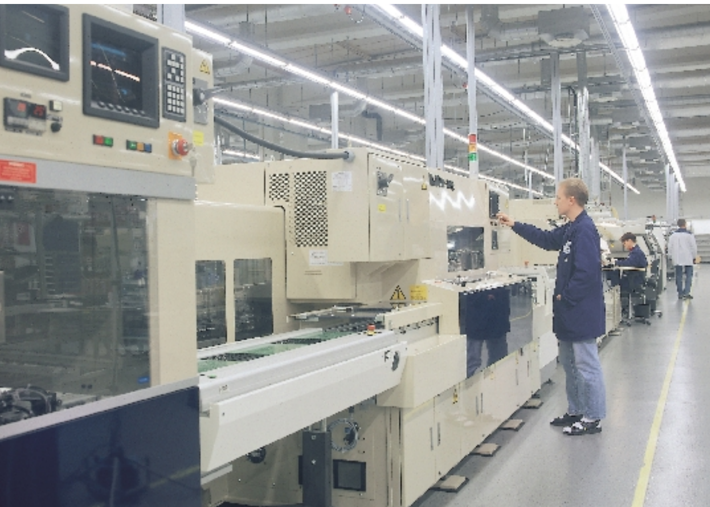
Saarijärven tehtaalla uusi SMT-tuotantolinja edustaa alan huipputekniikkaa.
