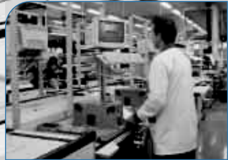
FPS-yksikkö kehitti Vaasa Control Oy:lle taajuusmuuttajien tuotantojärjestelmän, jossa tuotteet valmistuvat komponentti-vaiheesta lähetysspakkausiksi saakka.
