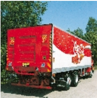
Zetecon valmistamilla Z-lyften-, Zepro ja Waltco- takalaitanostimilla on vahva kansainvälinen markkina-asema. Takalaitanostimia käytetään jakeluautoissa tavaroiden lastaamiseen ja purkamiseen. Kaikille malleille yhteistä on hydraulikka.
