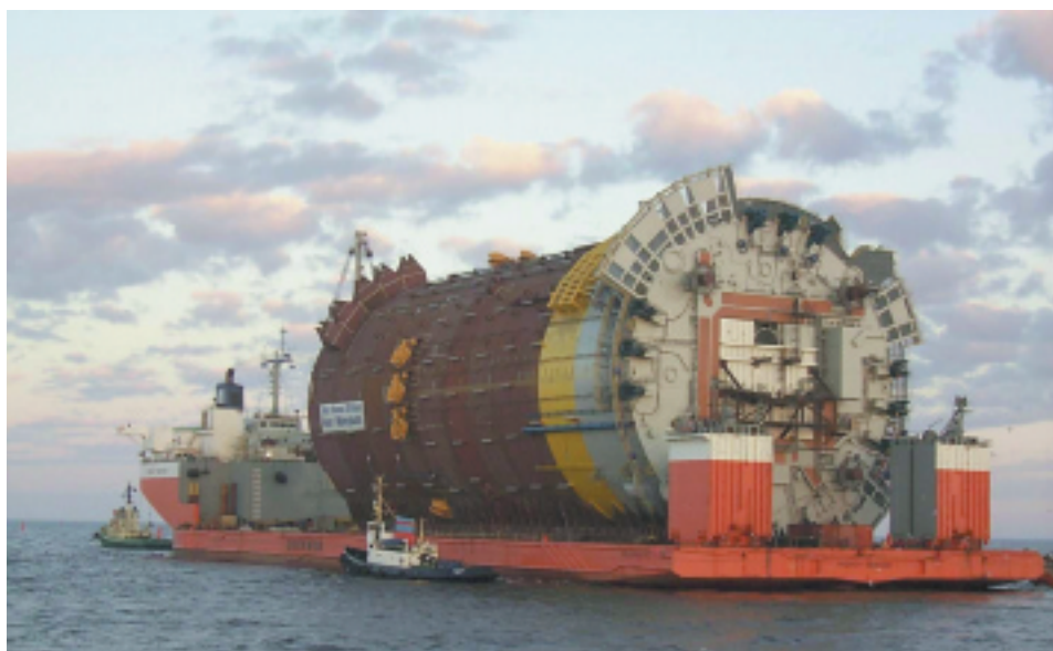
Aker Rauma Offshoren toimeksiannosta suunniteltu öljyntuotantolautan runko lähdössä Aker Mäntyluodon telakalta kohti Meksikonlahtea.
