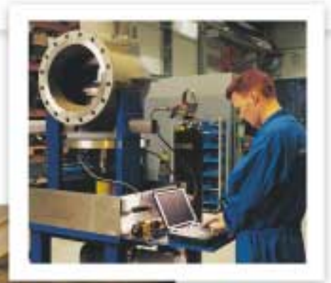
Väroventtiilien asetusarvojen testaus ja todennus Hakkilan toimintakeskuksessa.
