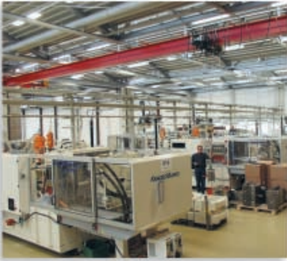
Kolme CXT nosturia toimitettiin lokakuussa Oechsler GmbH:lle Ansbachiin, Saksaan. Nosturit on varustettu uuden teknologian CXT köysinostimilla. Oeschler:n tehtaalla valmistetaan vaativia tarkkuusvaluja matkapuhe-linteollisuudelle.
