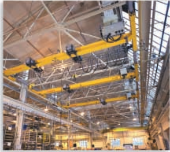
Kolmetoista kahdella köysinostimella varustettua CXT nosturia toimitettiin Rolls Roycen tehtaalle East Kilbrideen lähelle Glasgow:ta Skotlantiin. Nostureita käytetään lentokoneiden suihkumoottoreiden huoltamisessa ja testauksessa.
