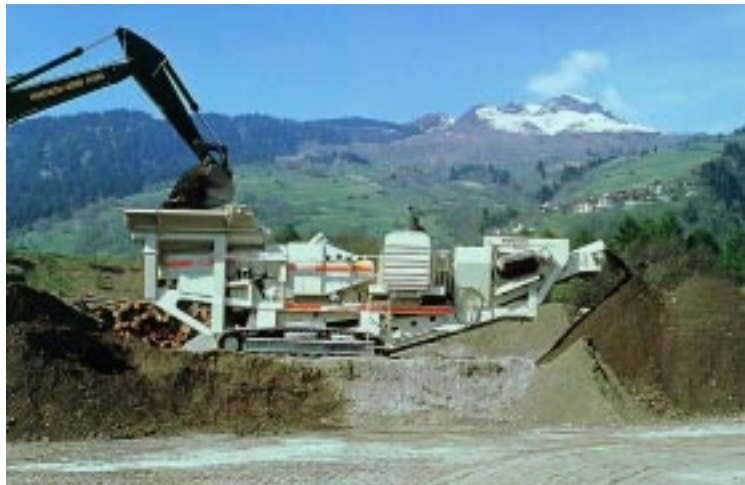
Kovaa kulutusta kestävä RAEX AR -teräs soveltuu mm. murskausasemien rakennusmateriaaliksi.
