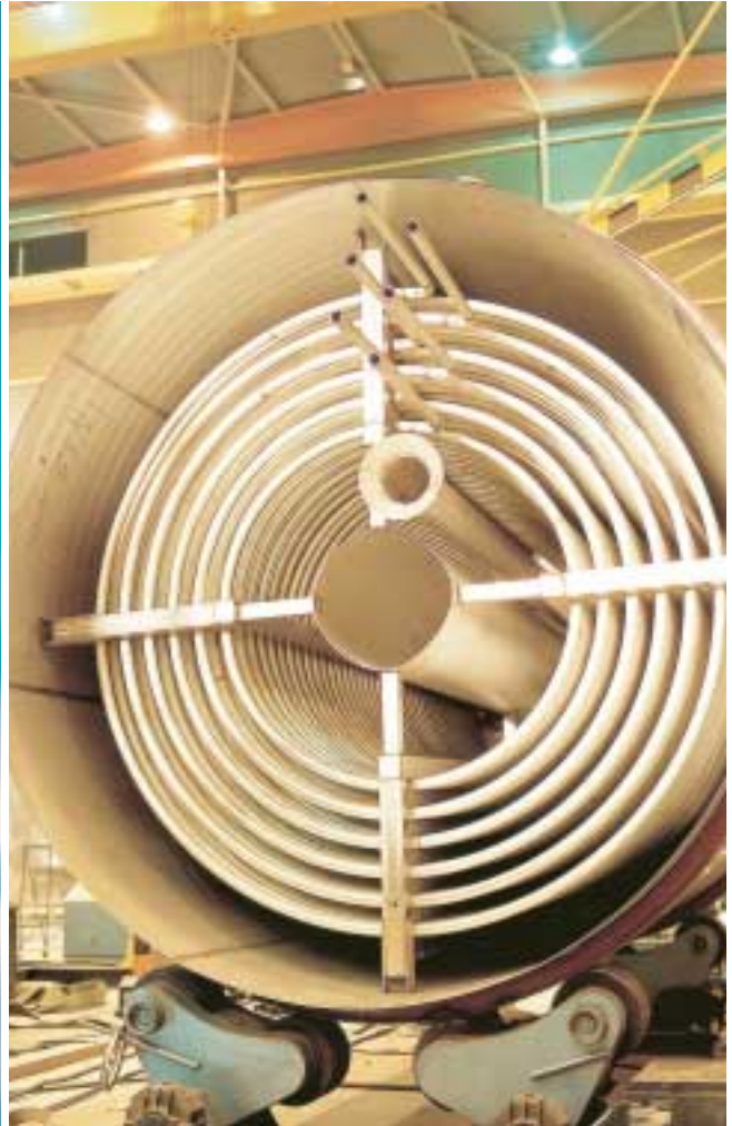
Finnstroi/Riga Penas Kombinat, jäävesisiilon putkikierukka
