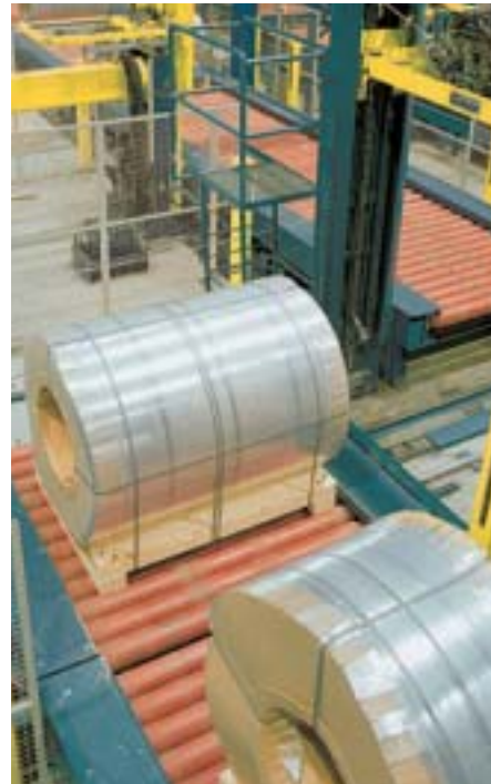
Ruostumaton teräs nauha leikataan ja halkaistaan eri mittaisiksi tuotteiksi käyttötarkoituksen mukaan.
