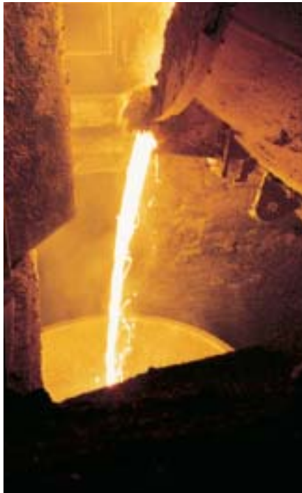
Teräsromu sulatetaan ja siihen lisätään seosaineita, kuten nikkeliä, molybdeenia ja kromia.
