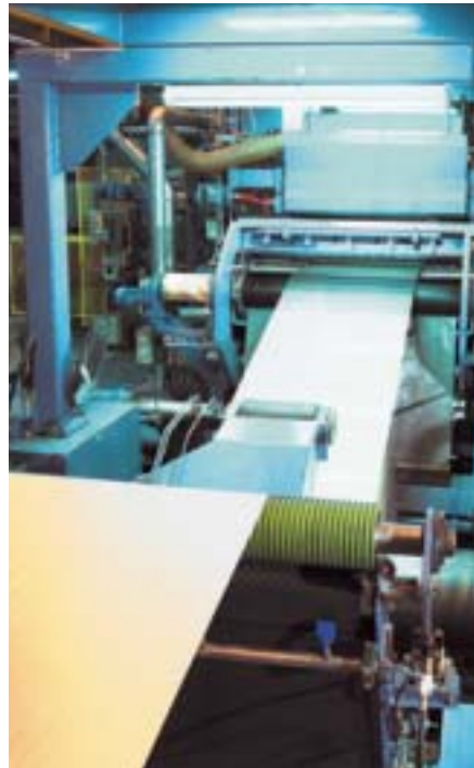
Kylmävalssaamossa kuumavalssattu nauha hehkutetaan, valssataan ja hehkutetaan lopuksi uudelleen. Kylmävalssausvaiheessa teräs voidaan valssata hyvin ohueksi nauhaksi.
