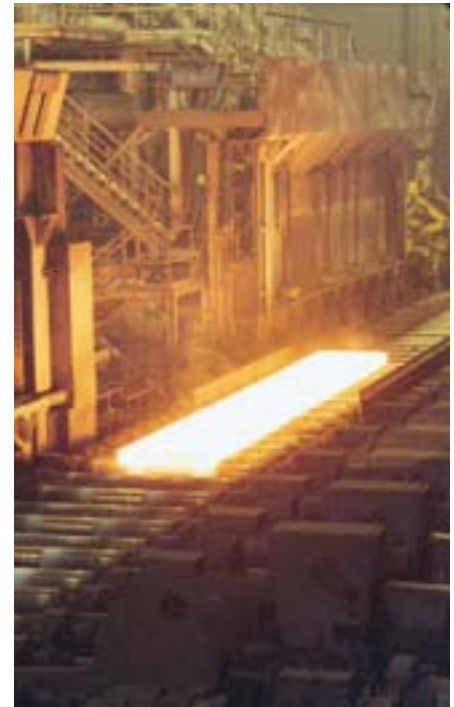
Valetut teräsaihiot valssataan kuumavalssaamossa nauhoiksi, joiden pituus voi olla jopa kilometri ja paksuus 2-12 mm.
