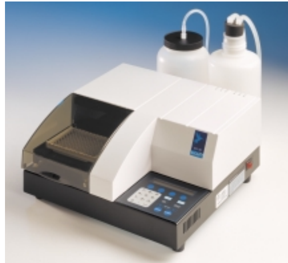
Biohitin mikrolevyvesuri, joka soveltuu tarkan pumpun ansiosta käytettäväksi myös nopeana nesteannostelijana.
