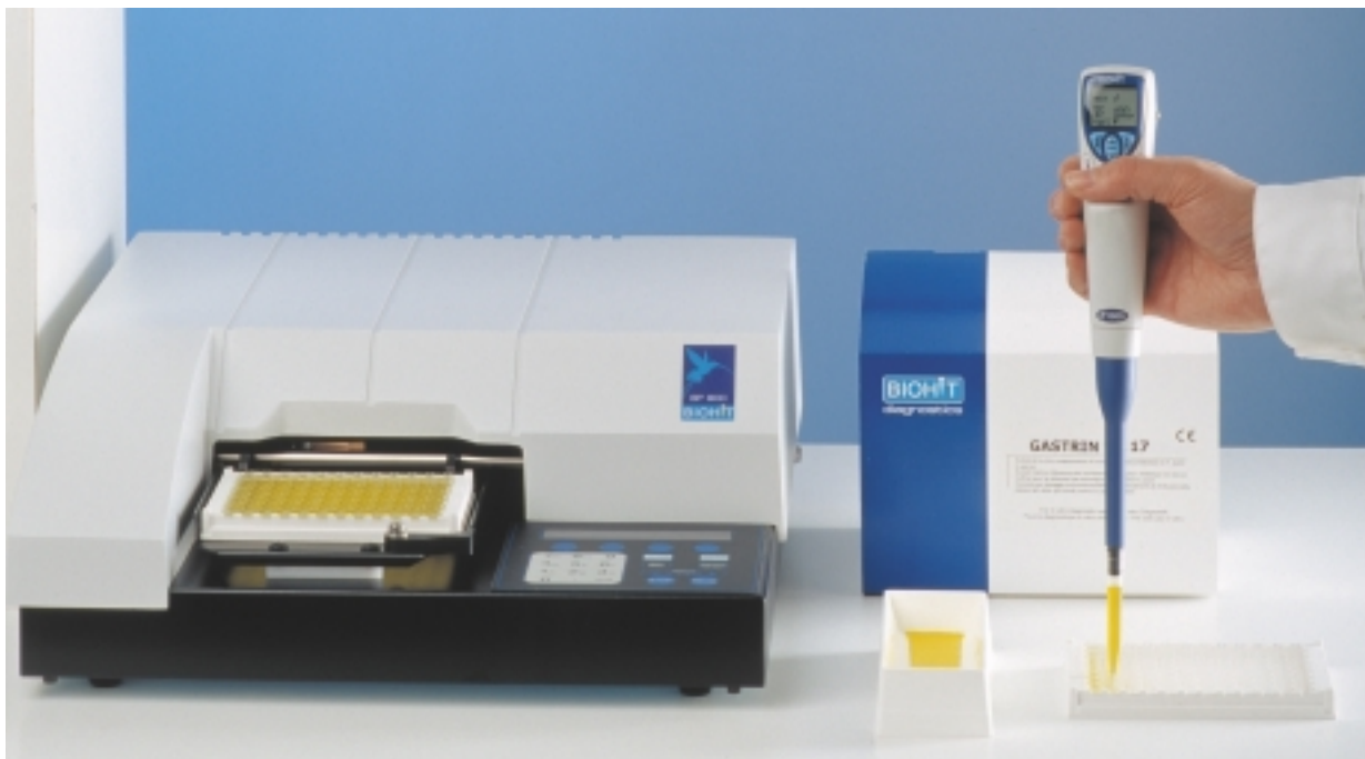
Biohitin mikrolevylukijat ja -pesurit toimitetaan valmiiksi ohjelmoituina Biohitin diagnostisten testien suorittamista varten. Kuvassa BP 800 mikrolevylukija ja gastriini-17-testi GastroPanel-kokonaisuudesta.
