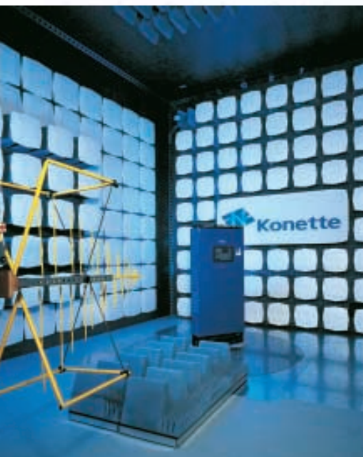
EMC-laboratoriossa voidaan tehdä täydelliset koneiden ja laitteiden sähkömagneettista yhteensopivuutta koskevat mittaukset.
