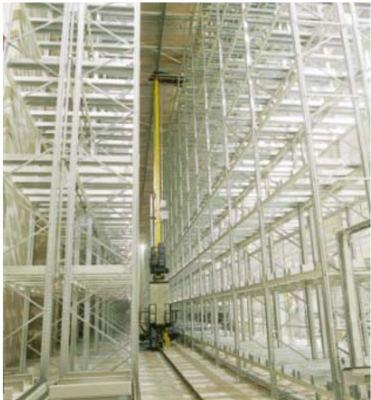
Tehtaan logistiikkamalli sisältää pitkälle automatisoidun korkeavaraston. Tavaravirtoja hallitaan reaaliaikaisesti raaka-ainehankinnoista täsmätoimituksiin.
