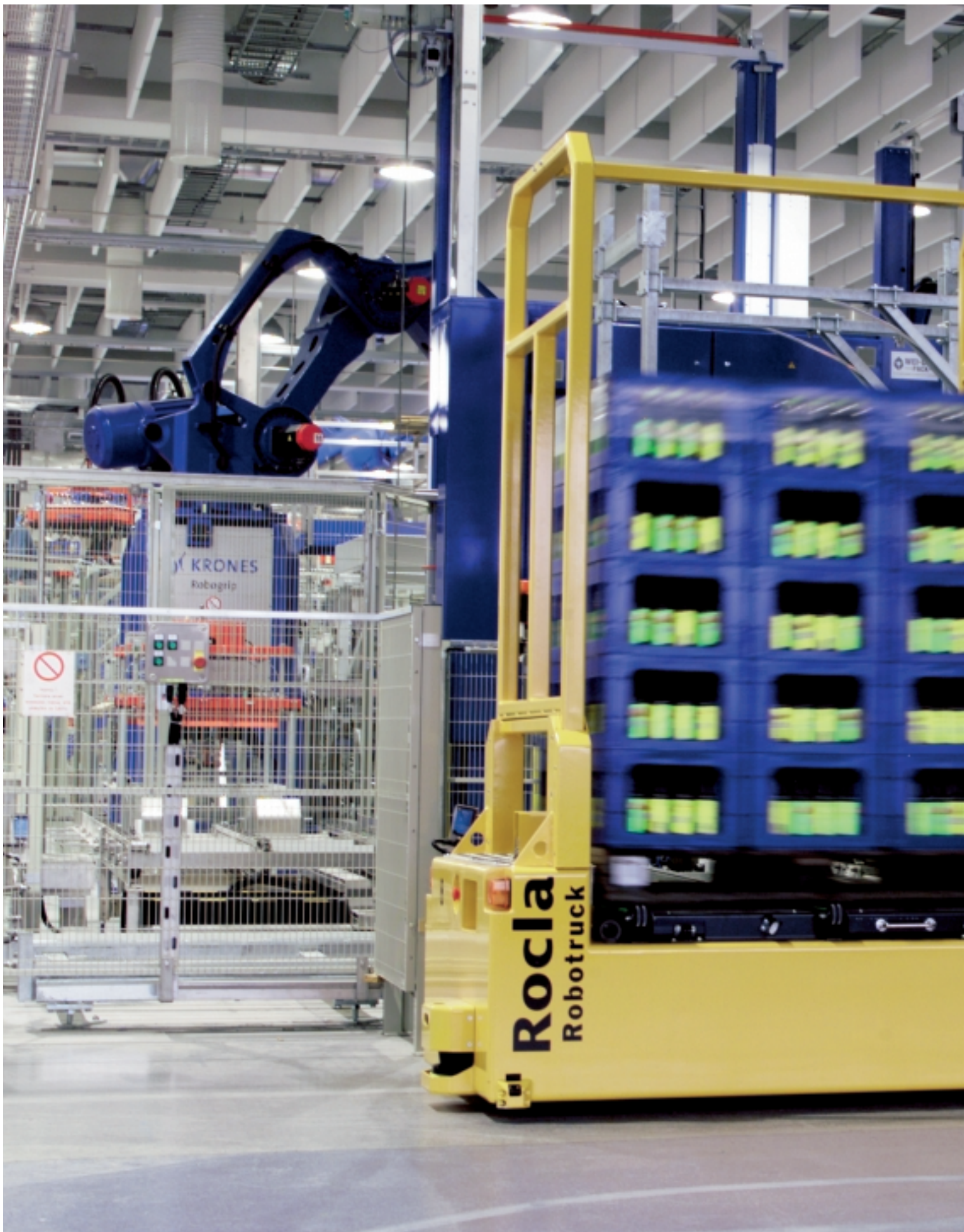
Rocla Robotruck toimitti keväällä 2001 erittäin edistyneen laserohjatun automaattitrukkijärjestelmän Hartwallin uudelle Lahden tehtaalle. Vuodenvaihteessa 2000–2001 sovittu 22
