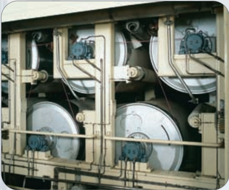
Vahto Oy toimitti mm. useita kuivatusosien uusintoja ja niihin liittyviä kuivatussyntereitä.
