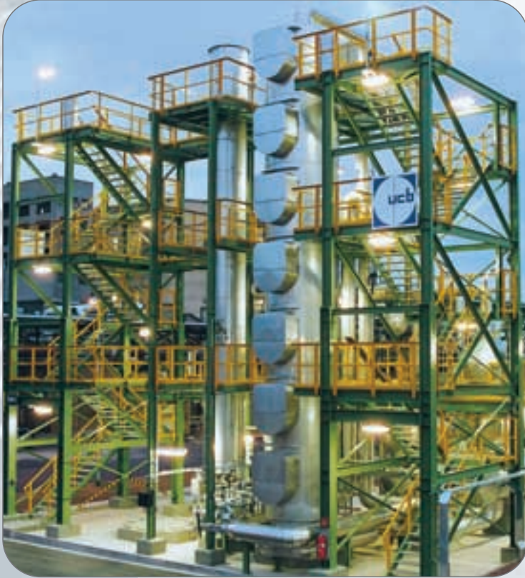
Saksaan toimitettuja lämmönvaihtimia ja kolonneja.
