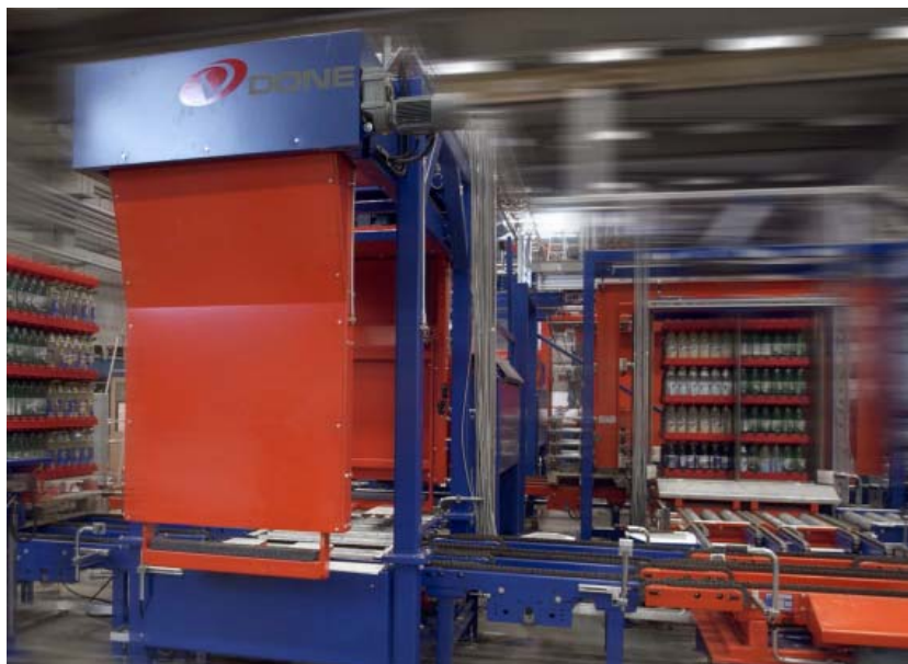
Logistics Systems -keruujärjestelmän sisäänsyöttö.
