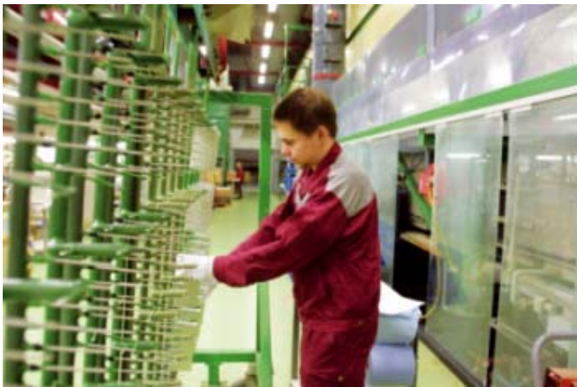
Automaattisella pinnoituslinjalla voidaan pinnoittaa useita tuoteyksiköitä samanaikaisesti käyttämällä tuotekohtaisesti räätälöityjä telineitä.
