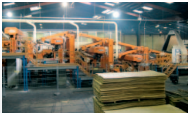
Ranskaan toimitetussa paikkauslinjassa sovellettiin Mecanon konenäköteknologiaa.
