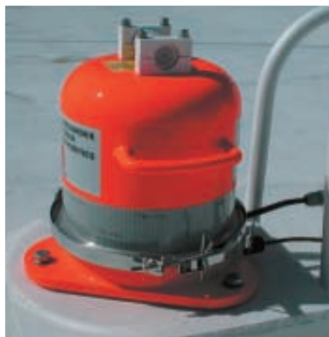
VDR tulee sanoista ”Voyage Data Recorder”, ja se on lentokoneen ”mustaa laatikkoa” vastaava ajopiirturi.
