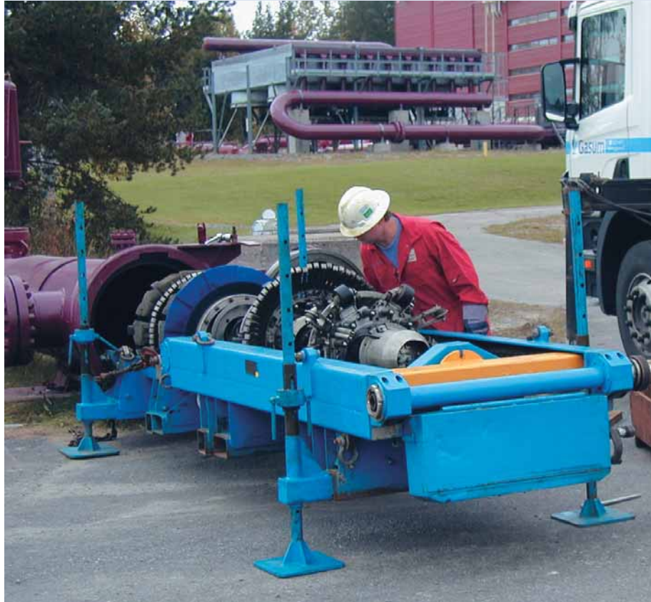
Lawrence Ling PII-Pipetronixista lähettää älykästä porsasta tarkastusmatkalle Imatran vastaanottoasemalta.
