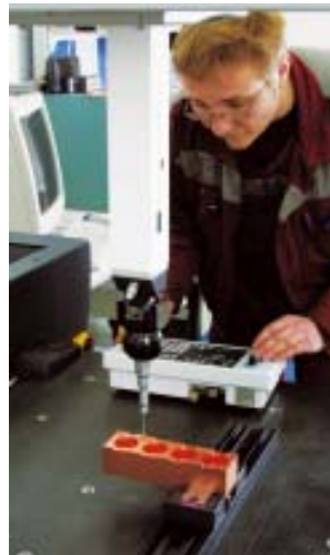
Koneistettujen tuotteiden laadunvarmistusta tehdään mm. koordinaattimittauskoneella.
