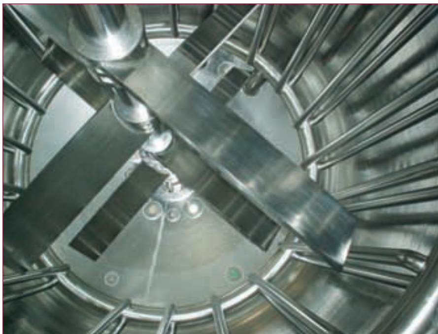
Kiinaan toimitettu sekoittimella varustettu kemianteollisuuden reaktori.
