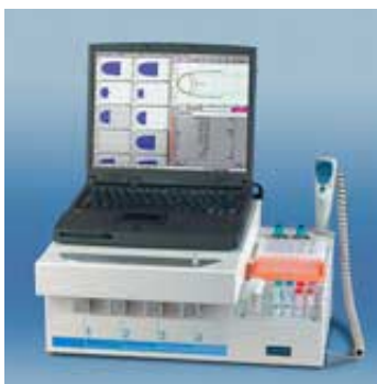
Kuva 1 Pentapharm GmbH, Saksa, on kehittänyt ROTEM®-järjestelmää käyttäen kokoveren Point-Of-Care-koagulaatiojärjestelmän. Järjestelmän yksi keskeinen osa on Biohitin elektroninen eLINE-pipetti. Järjestelmä koostuu havaitsemisjärjestelmästä, Biohitin elektronisesta eLINE-pipetistä, intuitiivisesta ohjelmistosta, reagenteista ja kertakäyttöisistä kyveteistä. Pienikokoista mittausyksikköä käytetään kannettavalla tietokoneella, joka on liitetty järjestelmään näppäimistön tai elektronisen pipetin kautta. Järjestelmä pystyy alentamaan verensiirtovaatimuksia kriittisissä leikkauksissa, kuten maksansiirroissa, sydänleikkauksissa, verisuonileikkauksissa, ortopedisissä leikkauksissa sekä traumakirurgiassa.
