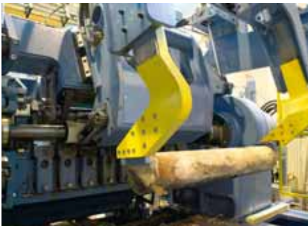
Smart Peel parantaa viilun saantoa, laatua ja tuotannon tehokkuutta.
