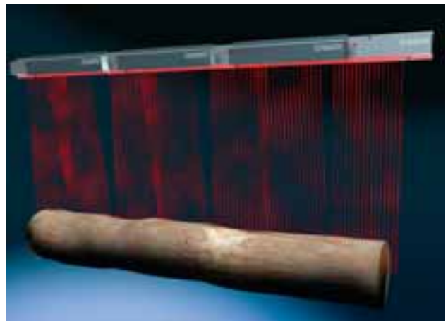
Smart Scan mittaa ja keskittää pöllin laserteknologian avulla.
