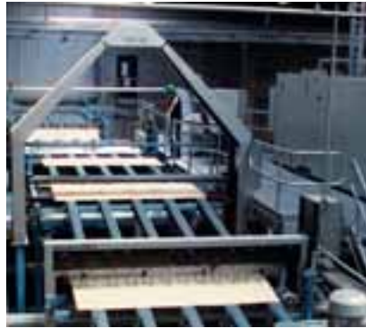
Konenäköjärjestelmä lajittelee viulun tehokkaasti ja tarkasti.
