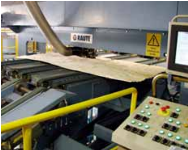
Suomessa automatisoitiin viulun paikkausta Rauten uusimmalla teknologialla.
