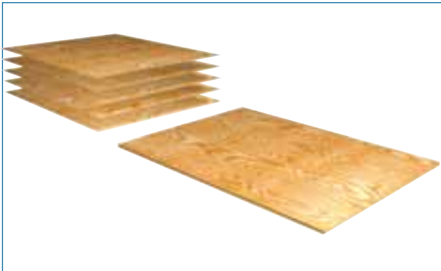
Vanerissa viilut ovat ristikkäin.
