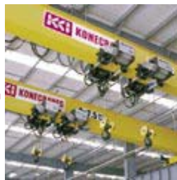
TEOLLISUUSNOSTURIT CXT-nostinten nostokapasiteetti ulottuu aina 100 tonniin asti.
