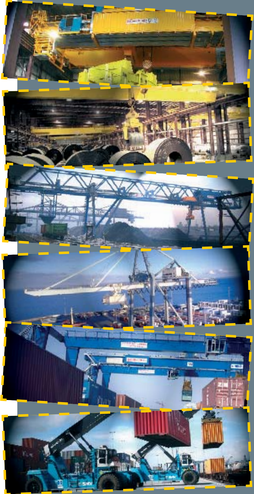
Kuvissa ylhäältä alas: Senkkanosturi, SMI Steel, Ybdysvallat • Teräskelanosturi, Heartland Steel, Indiana, Ybdysvallat • Hüllichmarinosturi, Magnitogorsk Iron & Steel Works, Venäjä • Laiturikontti-nosturi Årbusin satama, Tanska • RMG nosturi, Bilk-termiinaali, Budapest, Unkari • Konttikurottajia
