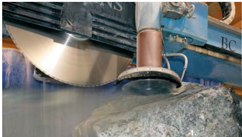
1. Mittatilaustehtaalla kuluneena vuonna käyttöön otettu block cutter –saha tehostaa vuolukiven käsittelyä.
