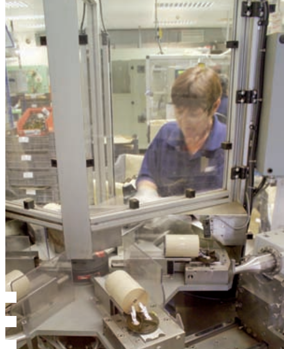
Elektrodikontaktien ultraäänihitsausta ja niittausta BHC Components:in tehtaalla.
