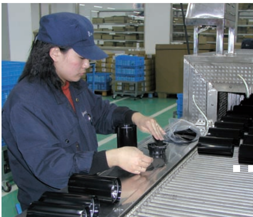
Muovieristeiden asennusta kondensaattoreiden ympärille Nantongin tehtaalla.
