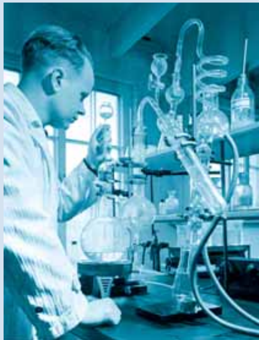
Maisteri O. Erik Virtanen valmistaa penisilliiniä Orionin tehtaalla vuonna 1945. Neutraloitu penisilliiniliuos jäädytetään, ja vesi poistetaan jäätyneenä alhaisessa paineessa, joka saadaan aikaan diffuusiopumpulla.
