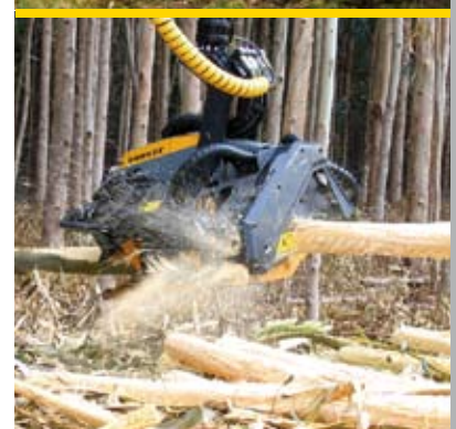
Joukkokäsittelevä PONSSE H53e -harvesteripää mahdollistaa usean rungon käsittelyn samanaikaisesti.
