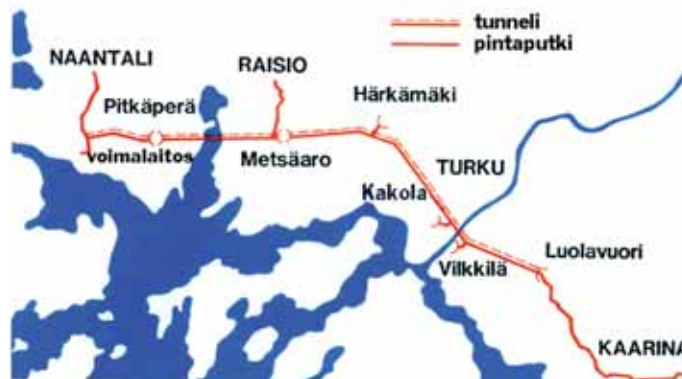
Turun Seudun Kaukolämpö Oy:n (TSK) siirtoverkko yhdistää Naantalintuotantolaitoksen, Raision, Turun ja Kaarinnan paikalliset kaukolämpöverkot Naantalintuotantolaitokseen. Siirtoyhteys sijaitsee pääosin maan alla 14,5 km mittaisessa tunnelissa. Turku Energia omistaa TSK:sta 60,75 %.
